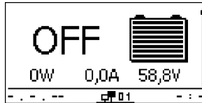
Abb. 7: Display nach dem Einschalten der externen Batteriesicherung
